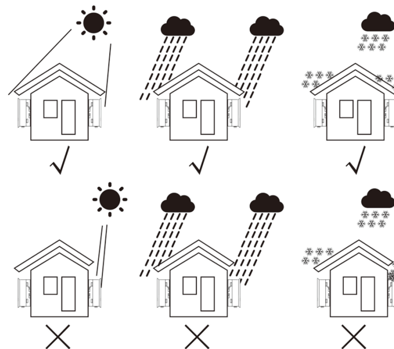
▲ Figura 4.1 Ubicaciones recomendadas para la instalación
