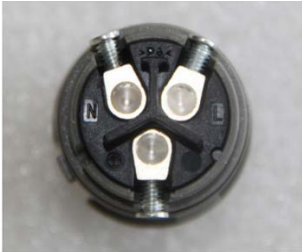
▲ Figura 4.13 Conector terminal de conexión a la red eléctrica de CA (vista interna) Todo inversor monofásico Beta Mini viene equipado con un conector terminal de conexión a la red eléctrica de CA.
